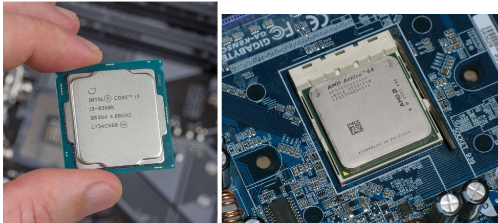
Figure 1.30 – Exemples de puces/processeurs. Reprise de «FuturaTech» [10]
